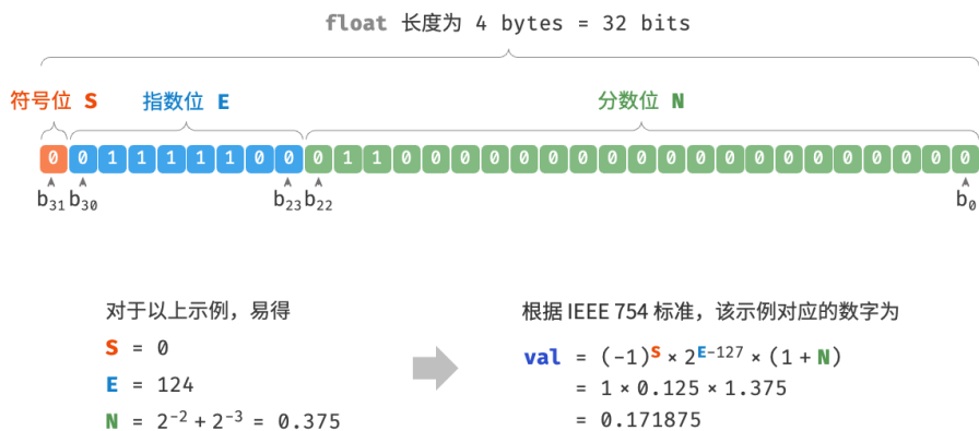
图 3-5 IEEE 754 标准下的 float 的计算示例
