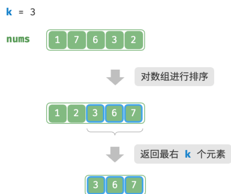
图 8-7 排序寻找最大的 k 个元素
