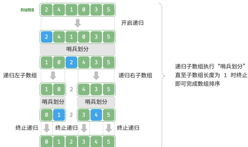
图 11-9 快速排序流程
