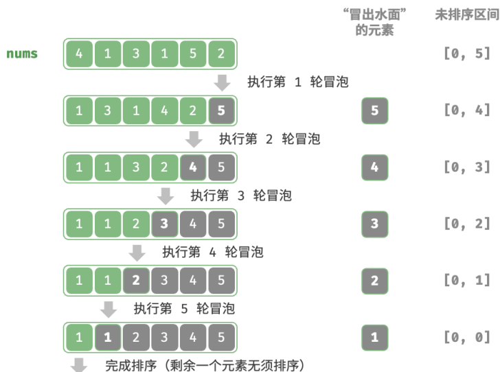
图 11-5 冒泡排序流程
